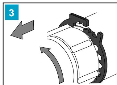
3 Повернуть ZAK<sup>®</sup>-соед. фитинг на 90° против часовой стрелки.
