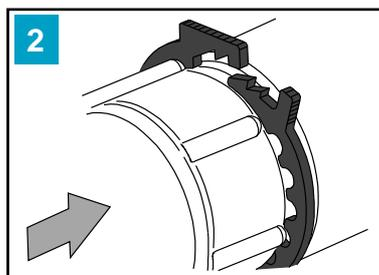
2 Втолкнуть ZAK<sup>®</sup>-соед. фитинг 4 мм до упора.
