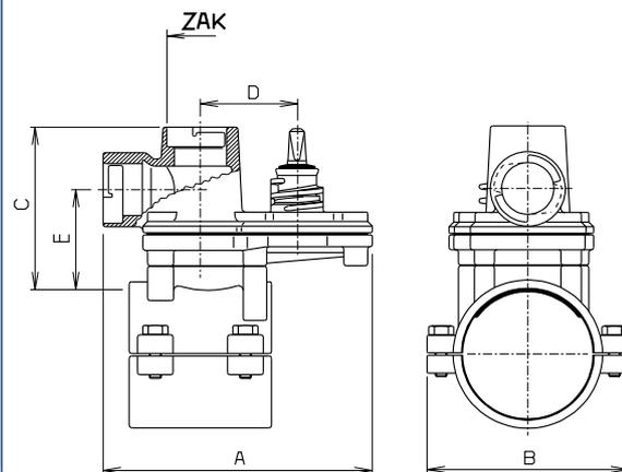
ZAK® Муфта d 34 макс. сверление diam. 25 мм
