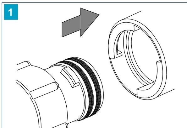
1 Смазать маслом O-образное кольцо конического патрубка и вставить ZAK<sup>®</sup>-патрубок в ZAK<sup>®</sup>-муфте до упора.
