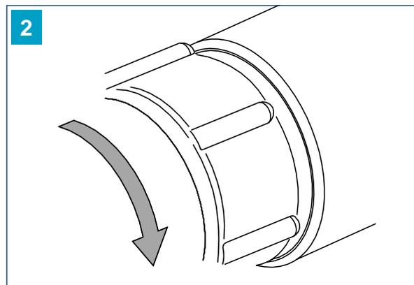
2 Повернуть ZAK<sup>®</sup>-соед. фитинг по часовой стрелке на 90° до упора.
