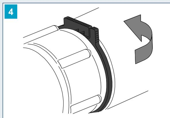
4 Отодвигать защитное кольцо в промежутке и нажимать до сцепления зубцов. (Защитное кольцо можно оставлять так, чтобы потом кольцо можно было дополнительно втолкнуть.)
