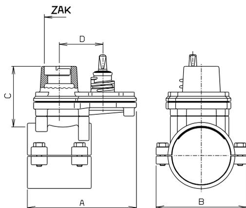
ZAK® Муфта d 34 макс. сверление diam. 25 мм
